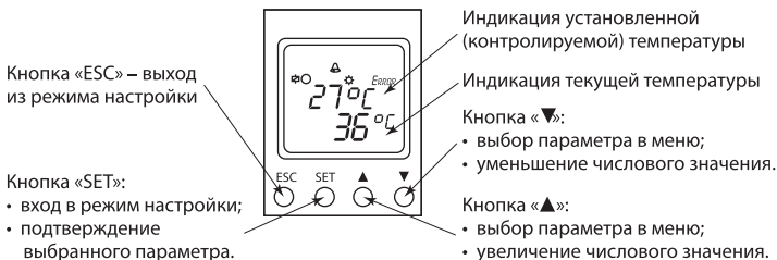
Рисунок 6. Показания дисплея реле РТ-820М
