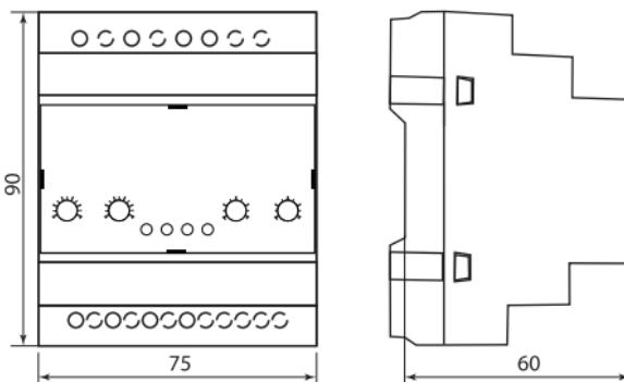
Рисунок 1. Габаритные и установочные размеры переключателей, мм
