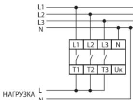
Схема подключения при нагрузке менее 16 А
