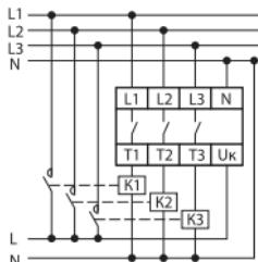
Схема подключения при нагрузке более 16 А
