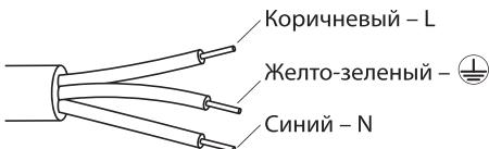
Рисунок 1. Схема подключения
