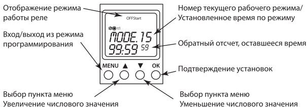
Рисунок 4. Показания дисплея и управляющие элементы реле
