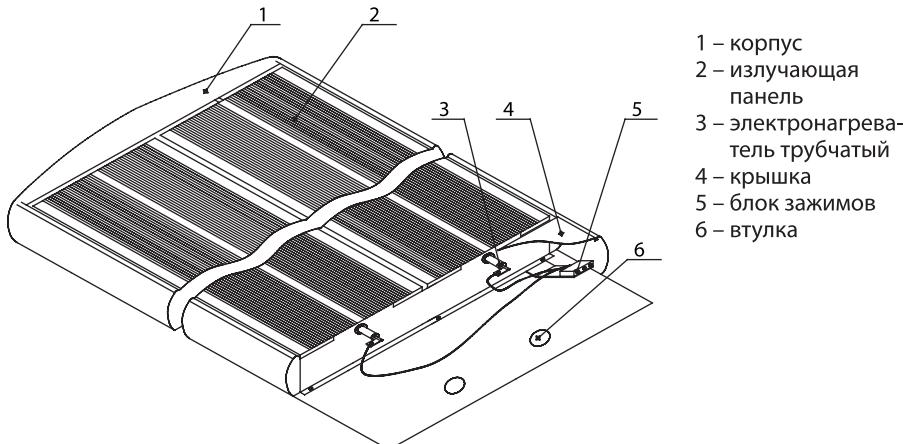
Рисунок 2. Обогреватель ИК 2,0 кВт
