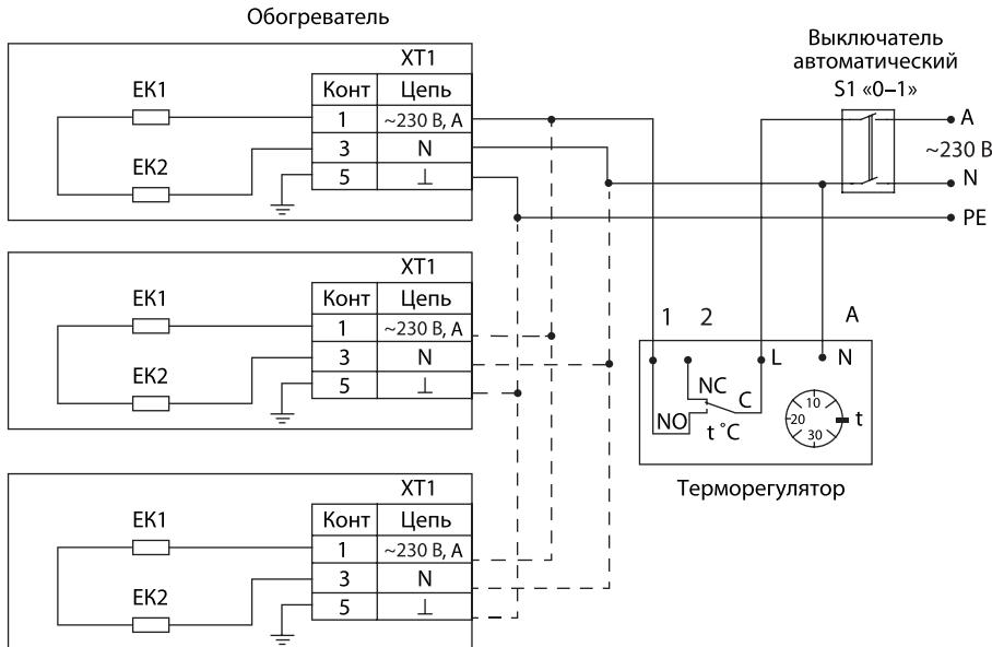
Рисунок 7. Схема подключения к стационарной проводке через терморегулятор для обогревателя ИК 2,0 кВт
