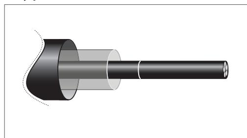
7.2. Для защиты внутренней поверхности трубки-коуха надвинуть на конец одного из соединяемых кабелей полиэтиленовый рукав (для муфт на сечения 10/25, 25/50 и 70/120 мм<sup>2</sup> используйте упаковочный рукав, предварительно обрезав его торцы, для муфт на сечение 150/240 мм<sup>2</sup> используйте монтажный рукав из комплекта муфты). Поверх полиэтиленового рукава надеть трубку-коух. Сдвинуть трубку-коух вместе с полиэтиленовым рукавом вдоль кабеля за кольцевой надрез.
