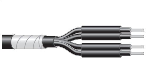
7.6. Надеть на жилы одного из кабелей трубки изоляции соединителей/гильз и сдвинуть их в сторону разделки кабеля до упора.
