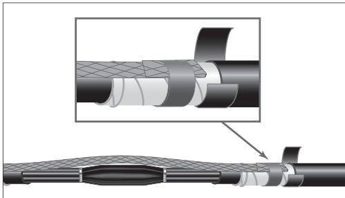
7.12. Оболочку обернуть по срезу герметиком ГКВ на обоих соединяемых кабелях.
