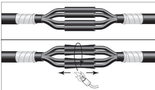
7.8. Надвинуть на соединители/гильзы трубы изоляции соединителей/гильз и выровнять их симметрично.
