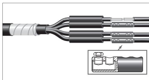
7.7. Соединить жилы соединителями/гильзами. При использовании соединителей/гильз с контактными болтами плавно, без резких движений, затянуть болты до срыва головок, придерживая соединитель/гильзу специальным приспособлением. Выступы болтов удалить напильником.
