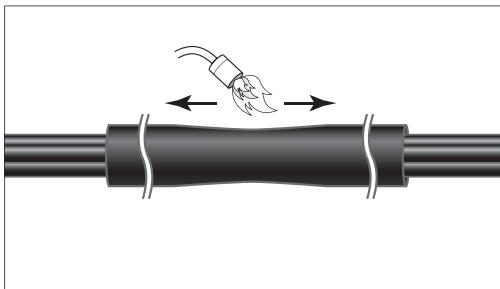
7.13. Надвинуть трубку кожух на место соединения кабелей, расположить ее симметрично относительно центра соединения.
