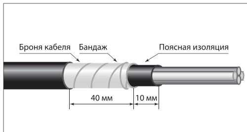
7.4. На расстоянии 40 мм от среза оболочки пропустить ножом кольцевую линию по броне. Размотать ленты брони и отрезать их ножницами по проведенной линии. Ленты брони плотно закрепить проволочным бандажом.
