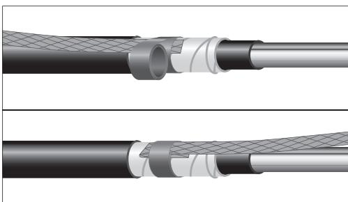
7.10. Бронеленты очистить до металлического блеска. Расплести конец жилы заземления длиной не менее 60 мм и разместить его поверх бронелент в направлении кабеля. Обернуть роликовую пружину дважды вокруг бронелент с наложенным проводом заземления. Отогнуть конец провода заземления в обратном направлении, в сторону второго кабеля, и довернуть всю роликовую пружину.
