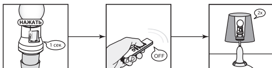
Рисунок 6. Пример отключения пультов ПУЗ, ПУБ от приемника П1-Е27 «Уютный дом»
