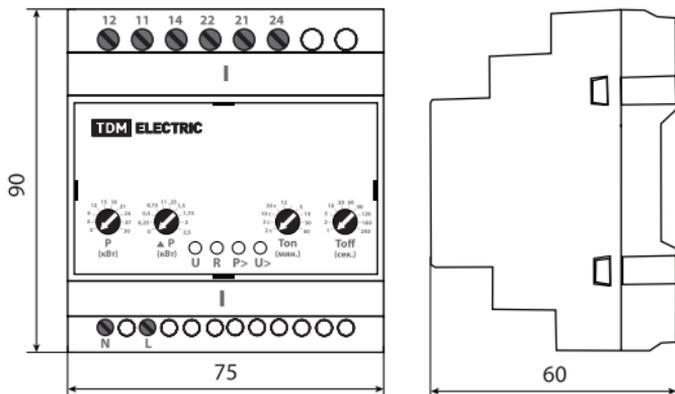
Рисунок 2. Габаритные и установочные размеры ограничителей мощности ОМ-1, М-630М.
