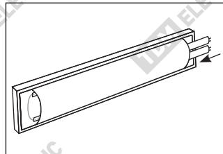
5.3.5. Установите светодиодную лампу в светильник.
