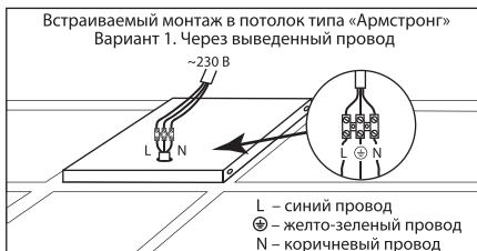
2. Подключите светильник к сети 230 В через выведенный провод с помощью внешней клеммной колодки (в комплект поставки не входит) и зафиксируйте светильник в монтажном отверстии (для артикулов SQ0329-0239, SQ0329-0240, SQ0329-0279, SQ0329-0280, SQ0329-0281, SQ0329-0276, SQ0329-0277, SQ0329-0278).
