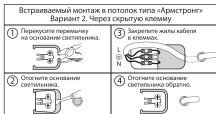
3. Подключите светильник к сети 230 В через скрытую клемму (для артикулов SQ0329-0600, SQ0329-0605, SQ0329-0608, SQ0329-0609, SQ0329-0267, SQ0329-0268).
